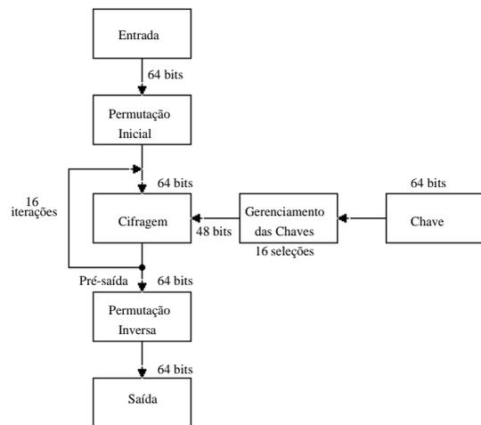
A figura abaixo ilustra o as funções do sistema DES em forma de diagrama de blocos:
